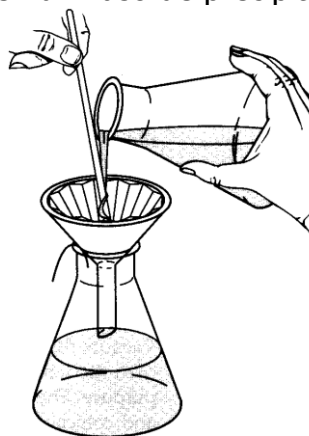
Figura 3.4: Técnica correcta para filtración por gravedad
